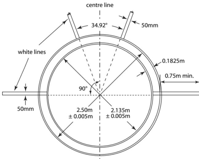
**Figure (d) TR32 (Rule 187) - Layout of concentric circles for Discus and Hammer Throw circle**
